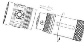
Um den Akku herauszunehmen, drehen Sie den unteren Teil der Lampe in Uhrzeiger Richtung auf und nehmen ihn nach unten weg. Achten Sie immer auf Abrieb der O-Ringe, ggf. tauschen Sie diese aus. Nutzen Sie nur den original Akku von TREE scuba. Die Ladezeit variiert je nach Ladegerät.
